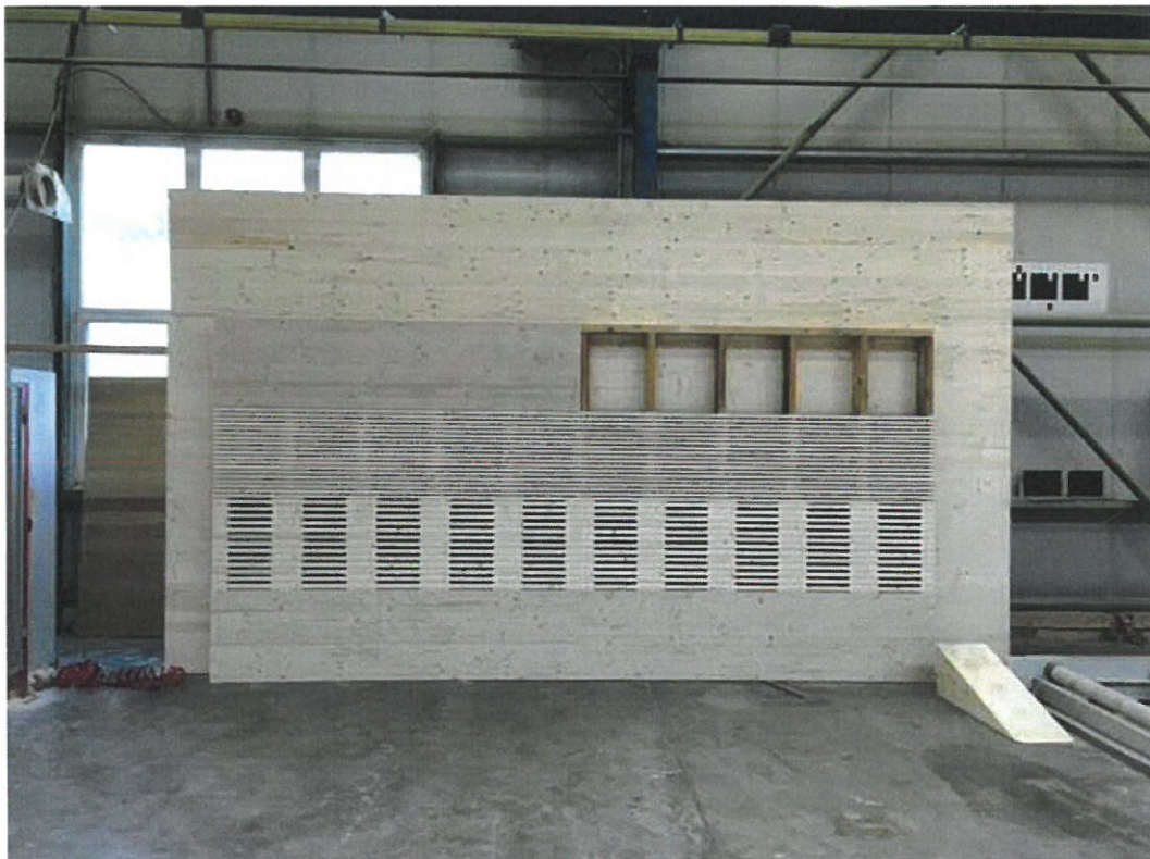
Abb. 1: Wandverkleidungs-Prüfmuster - Gesamt-Ansicht; Prüfung am 18.05.2017; unterste Ebene: Paneel-Varianten „Lucy 8/16/16“ (gelocht); 2.Ebene von unten: „ Suzanna “ (geschlitzt); 3.Ebene von unten/links: „ Marilyne 8/25 “; rechts: „ Marilyne 8/25 - WeissTanne “ (geschlitzt); 4.Ebene von unten/links: „ Marilyne 4/12 “; rechts: „ Marilyne 4/12 - WeissTanne “ (geschlitzt)
