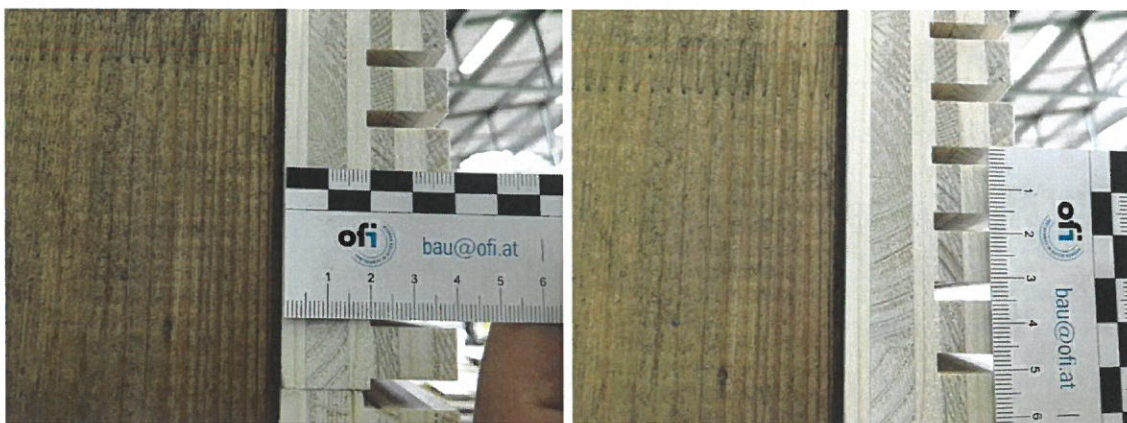
Abb. 12 - 13: Wandverkleidungsmuster-Teil mit der Paneel-Variante „Marilyne 4/12“ - und „Marilyne 4/12 - WeissTanne“ (geschlitzt): konstruktive Details; Prüfung am 18.05.2017
