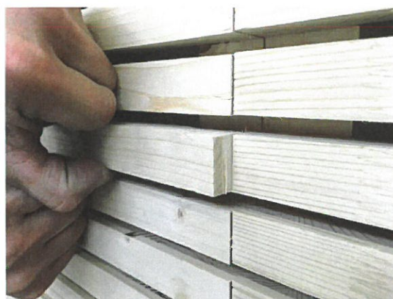
Abb. 16: Wandverkleidungsmuster-Teil mit der Paneel-Variante „Marilyne 8/25“, „Marilyne 8/25 - Weisstanne“ (geschlitzt): Schäden bei Beschuss mit dem Hockeyball; Prüfung am 18.05.2017
