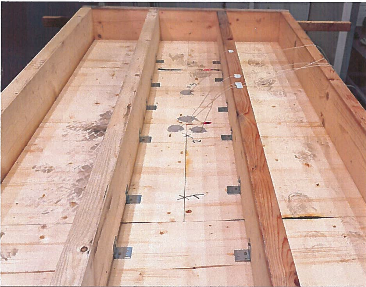
Obr. 10 Pohled na vzorek EASY tloušťky 19 mm během zkoušky ve 21. minutě
