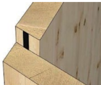
DETAIL ROHOVÉHO SPOJE (cca 135° a více), VS 124, 84 a 62 / Detail von Eckverbindung (ca. 135° und mehr) 124, 84 u. 62
