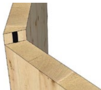
DETAIL ROHOVÉHO SPOJE (cca 135° a více), VS 124, 84 a 62 / Detail von Eckverbindung (ca. 135° und mehr) 124, 84 u. 62
