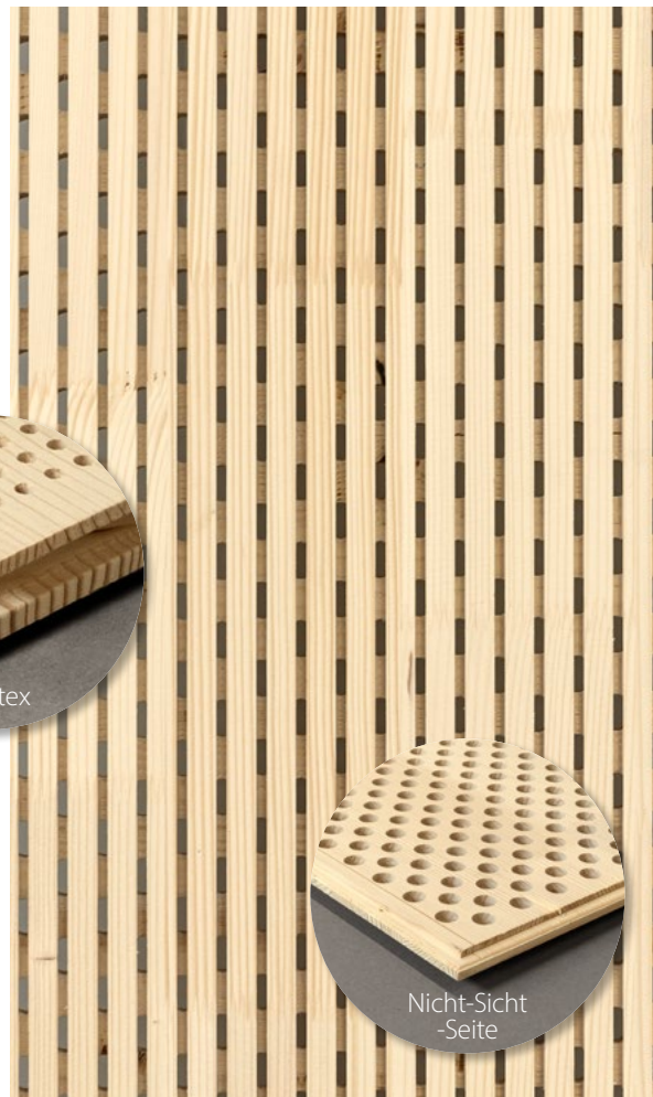
Profil S/L – Sichtseite Nuten 4/12, Nicht-Sichtseite Bohren 16/32-32
