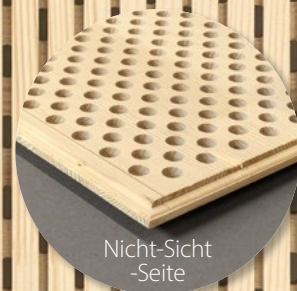
Profil S/L – Sichtseite Nuten 4/12, Nicht-Sichtseite Bohren 16/32-32
